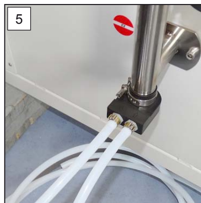
5. Fixieren Sie die Schläuche mit Schlauchschellen, z. B. mit einer Flachzange.
