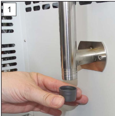
1. Ziehen Sie die Blindkappe unten vom Abgasrohr.
